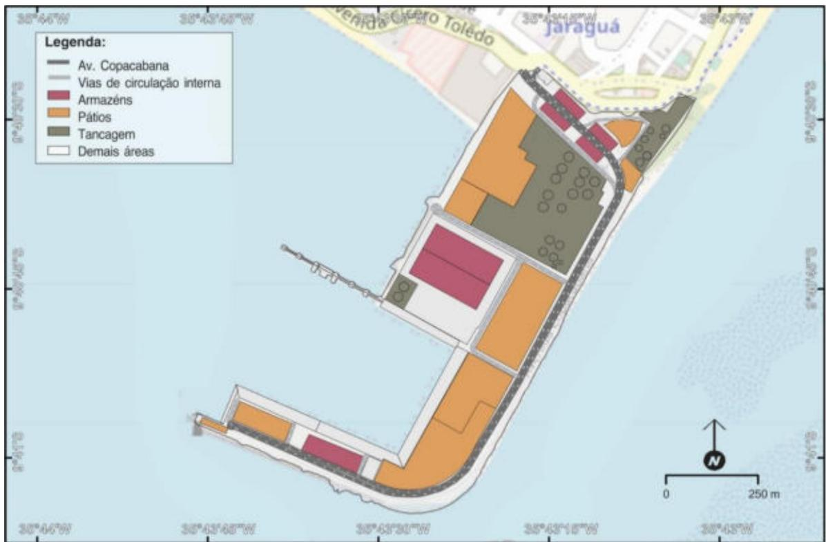
Figura 24 – Configuração das instalações de armazenamento no horizonte de curto prazo
