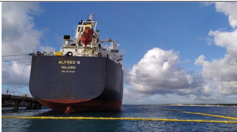
Figura 34 – Barreiras de contenção dedicadas no Píer da Braskem Maceió, utilizadas em rotina de cerco preventivo. Fonte: PEI Braskem.
