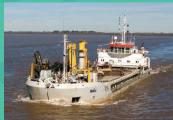
Figura 2: Draga autotransportadora de sucção por arrasto
