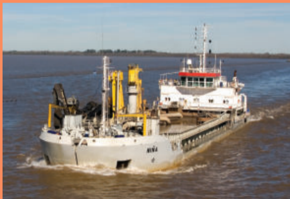
Figura 2: Draga autotransportadora de sucção por arrasto
